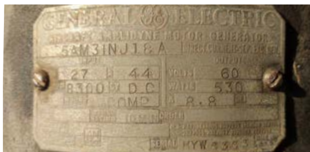
Tabliczka znamionowa generatora prądu.
